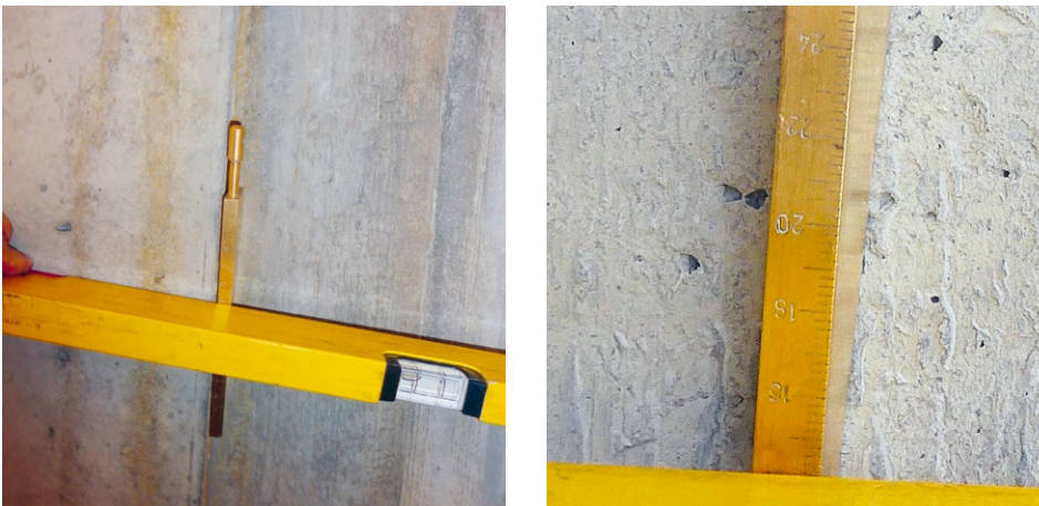
Abb.36: Messung der Ebenheit mit einem Messkeil; Stichmass von ca. 18 mm (links) und ca. 14 mm (rechts)
